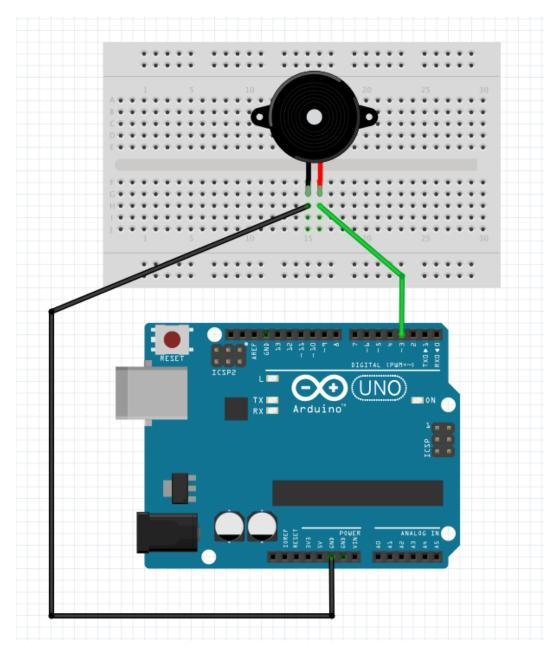
Piezo wiring diagram
